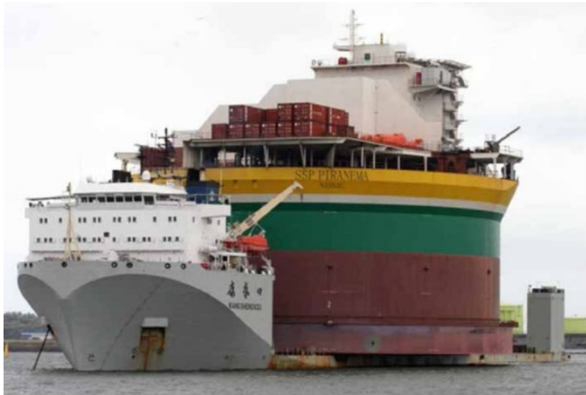
Figura II.2 – Exemplo de um tipo de Floating Production, Storage and Offloading Monocoluna, que estava instalado no Campo de Piranema, na Bacia de Sergipe. Foto do transporte da Plataforma para o Brasil em Navio heavy lify, que é uma das ferramentas disponíveis para o manejo de bioincrustação.
