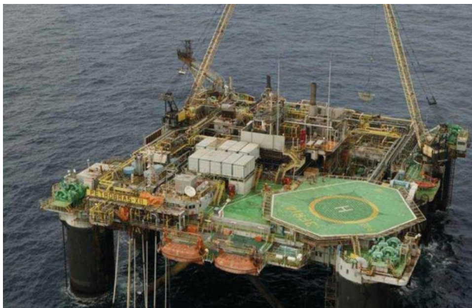
Figura II.3 – Exemplo de um tipo de SS (Semisubmersível), P-12 PETROBRAS – XII, Descomissionada em 31/12/2020 destino a Walvis Bay/Namíbia. Fonte: 2º Relatório Periódico das Operações de Descomissionamento (SEi nº 8398929 – Processo 02001.124307/2017-77.
