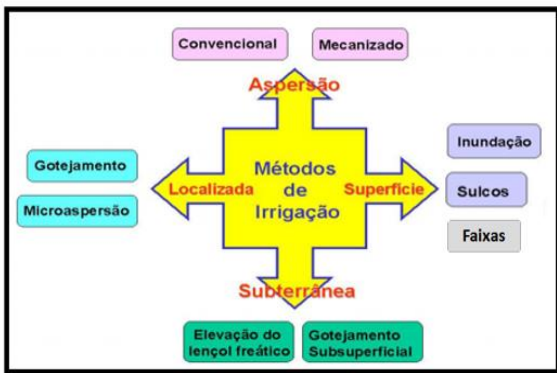
Figura 3.4.2: Métodos de irrigação e seus principais sistemas.
