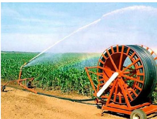
Figura 3.4.13: Sistema de irrigação por aspersores autopropelidos tipo Carretel enrolador.
