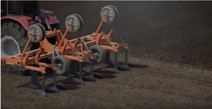
Figura 4.3.1: Implementação dos tubos gotejadores por meio de tratores.
