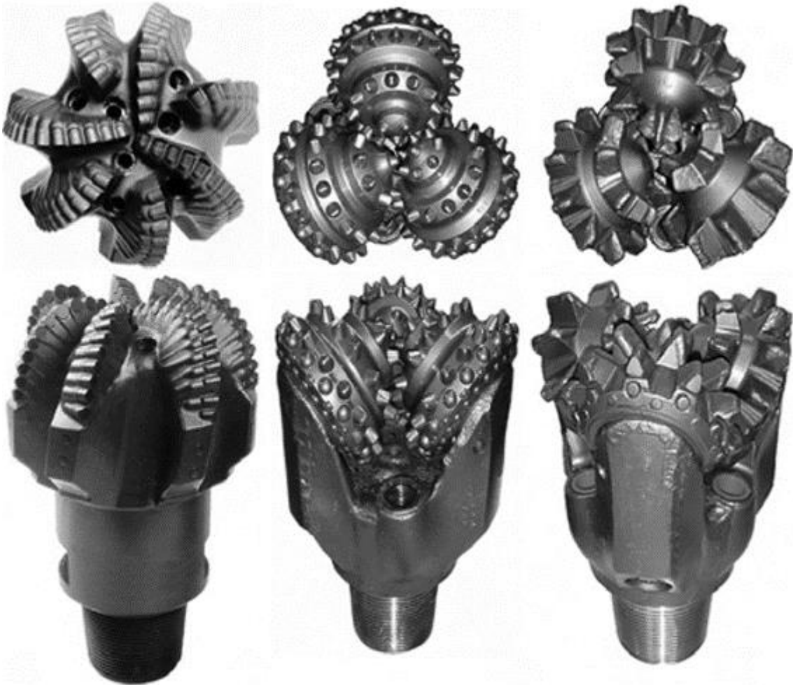
Figura 58: Exemplos de brocas utilizadas na perfuração de poços de petróleo. Cada geometria e composição material é ajustada à geologia da seção do poço sendo perfurado. Fonte: Wamsley e Ford (2006).
