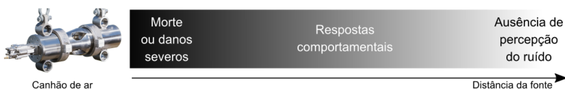
Figura 55: Esquema genérico do gradiente de interferência dos pulsos sísmicos na vida marinha. Fonte: elaboração própria.
