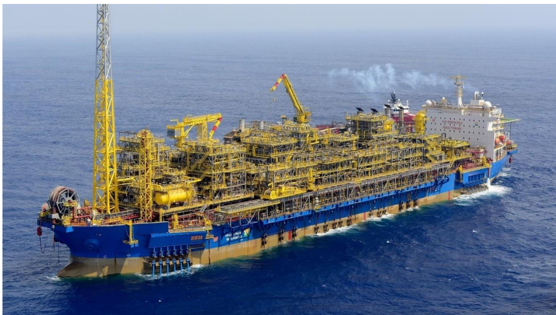
Figura 76: FPSO Cidade de Ilhabela, operando para a Petrobras no campo de Sapinhoá, bacia de Santos. Destaque para a planta de processo ocupando boa parte do convés da embarcação. Fonte: Petrobras (2022b).
